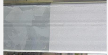
Film de **GALVA BRILLANT** sur de la tôle galvanisée
